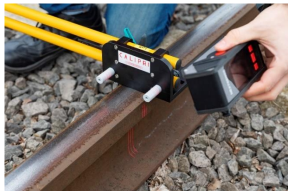
Messung des linken Schienenprofils
