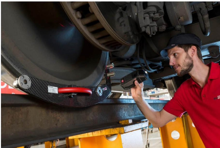
Messung des Raddurchmessers mit Sensor und D-Lehre
