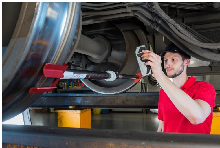
BackToBack-Abstandsmessung mit CALIPRI
