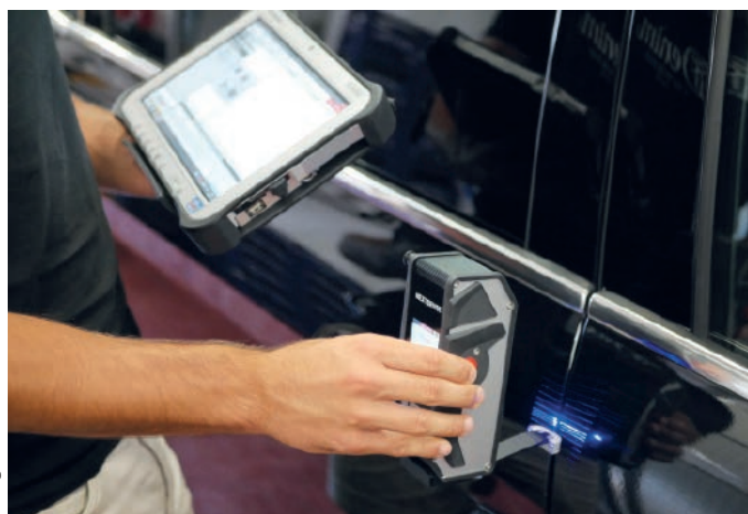
Kabelloses Spalt- und Versatzmessgerät Calipri C14 für die Stichprobenprüfungen
